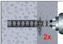
2b. Bohrloch mit geeigneter Drahtbürste gem. Tabelle B5 (minimaler Bürstendurchmesser  $d_{b,min}$  ist einzuhalten und zu überprüfen) 2x mittels eines Akkuschaubers oder Bohrmaschine ausbürsten. Bei tiefen Bohrlöchern Bürstenverlängerung benutzen (Tabelle B5).
