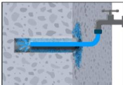
2c. Wiederholt mit Wasser ausspülen, bis klares Wasser aus dem Bohrloch austritt.
