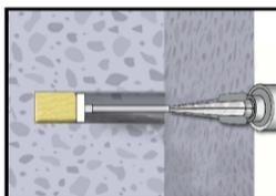
Für die Horizontal- oder Überkopfmontage sowie bei Bohrlochern tiefer als 240mm sind Verfüllstutzen zu verwenden.
