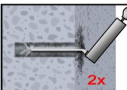
2f. Anschließend das Bohrloch erneut vom Bohrlochgrund her 2x vollständig mit Druckluft (min. 6 bar) und geeigneter Ausblasdüse gem. Tabelle B5 ausblasen. Bei tiefen Bohrlöchern sind geeignete Verlängerungen zu verwenden.
