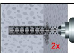
2e. Bohrloch mit geeigneter Drahtbürste gem. Tabelle B5 (minimaler Bürstendurchmesser  $d_{b,min}$  ist einzuhalten und zu überprüfen) 2x mittels eines Akkuschaubers oder einer Bohrmaschine ausbürsten. Bei tiefen Bohrlöchern ist eine geeignete Bürstenverlängerung zu benutzen.
